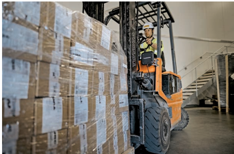
Vysokozdvížňové vozíky vybavené RFID čítačkami umožňujú spoľahlivú a rýchlu identifikáciu palet a kontajnerov.
